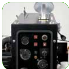
Проверка двигателя при старте с индикацией: - нет топлива; - выключение двигателя из-за нехватки смазки/топлива; - недостаточный заряд аккумулятора.
