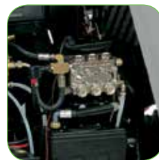
Кривошипно-шатунный насос высокого давления с тремя керамическими поршнями и никелированной головкой из ковanej латуни.
