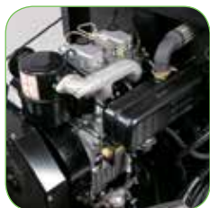
Двухцилиндровый дизельный двигатель Ruggerini RD 210 с электростартером.
