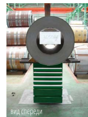
Иллюстрация тестирования тележки HANS 9917HQ под нагрузкой 3650кг.
