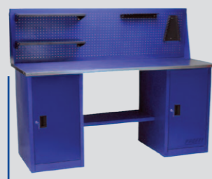
Верстак PROFFI-E 218 Т Т Э Столешница 1400 мм (фанера 24мм + оцинкованный металл 1 мм), две тумбы с дверцей, полка-стенка 777 мм, экран)
